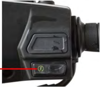
ΗΛΕΚΤΡΙΚΟΣ ΑΤΕΝΙΖΩΝ ΚΟΥΜΠΙ
