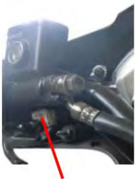
FR. ΦΡΕΝΟ ΝΔ. ΣΥΝΔΥΑΣΜΟΣ ΚΟΥΜΠΙ ΗΛΕΚΤΡΙΚΗΣ ΜΙΖΑΣ ΣΤΟ ΜΕΤΡΟ RR. ΦΡΕΝΟ ΝΔ. ΚΑΙ Ο ΣΥΝΔΕΣΜΟΣ ΤΟΥ ΣΤΟ ΚΥΡΙΟ ΚΑΛΩΔΙΟ
