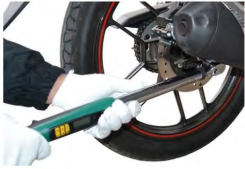
ΠΙΣΩ ΤΡΟΧΟ ΡΟΠΗ ΣΦΙΞΗΣ: 6080N.m
